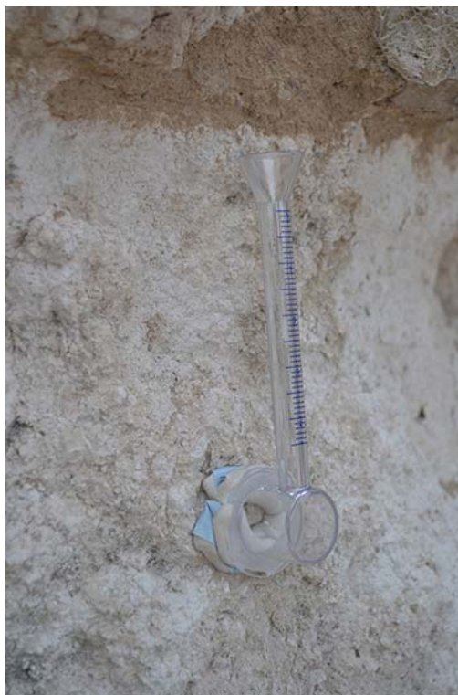
FIG.11.20. Detalle del ensayo de Karsten.
