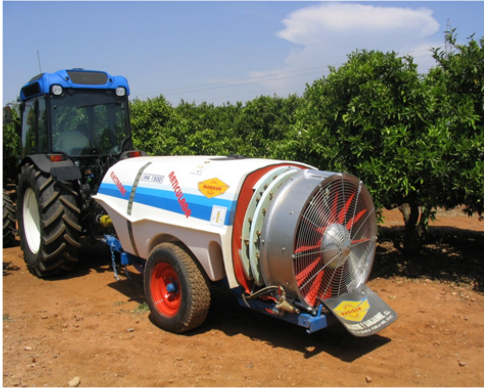
Figura 1: Equipo atomizador arrastrado por un tractor típicamente usado en los tratamientos cítricos en Valencia. La corriente del ventilador trasero orienta las gotas que salen de las boquillas hacia la copa de los árboles.
