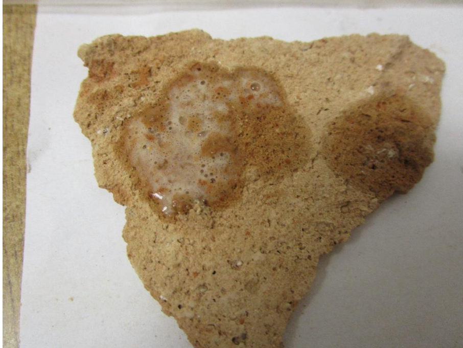
Fotografía 53. Efervescencia en la parte interior del enlucido
