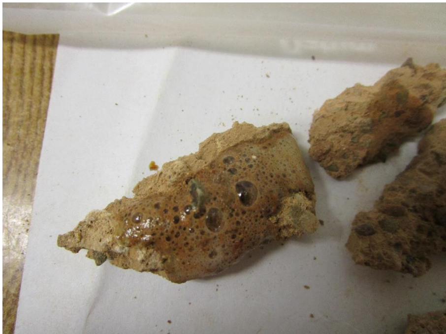
Fotografía 58. Efervescencia en la parte exterior del enlucido
