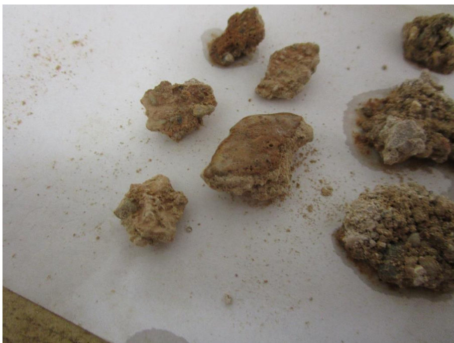
Fotografía 52. Efervescencia en la parte exterior del enlucido
