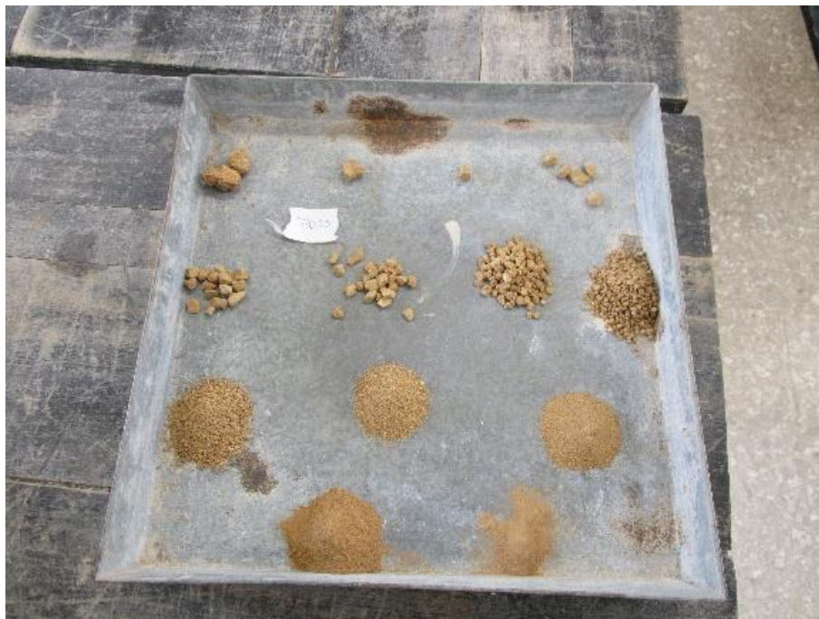
Fotografía 80. Muestra separa por tamaños de árido
