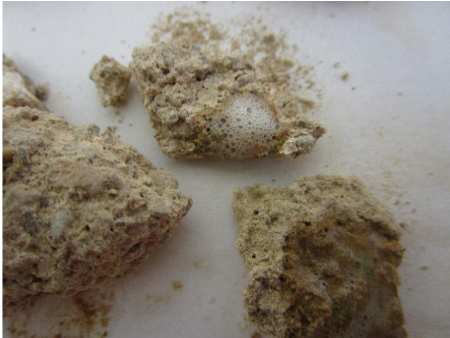
Fotografía 59. Efervescencia en la parte interior del enlucido
