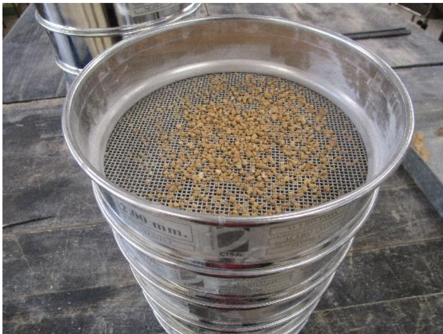
Fotografía 78. Muestra en tamices durante el proceso de tamizado
