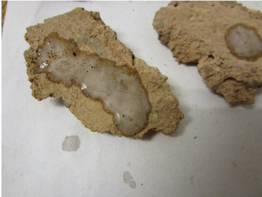
Fotografía 57. Efervescencia en la parte interior del enlucido
