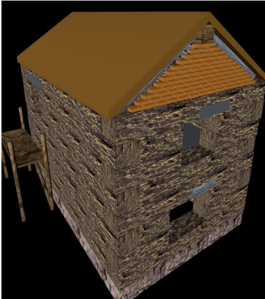
Ilustración 26. Colocación del cañizo y la teja
