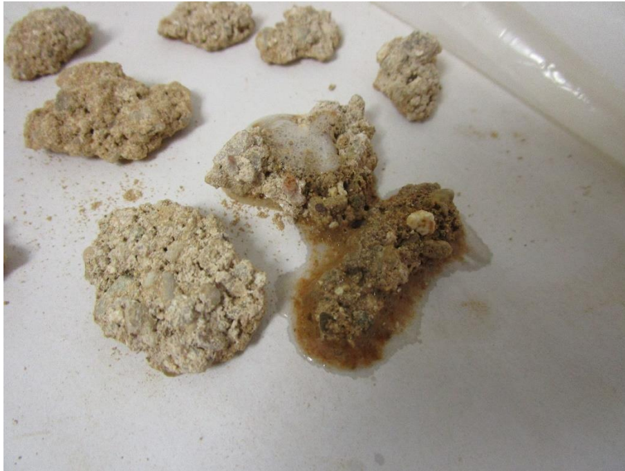
Fotografía 51. Efervescencia en la parte interior del enlucido
