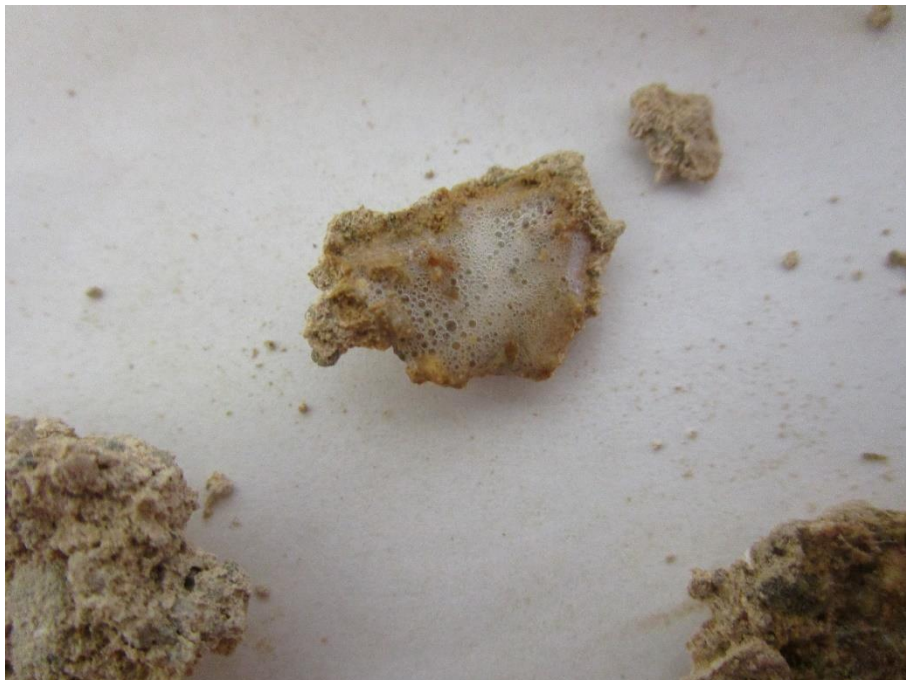
Fotografía 60. Efervescencia en la parte exterior del enlucido
