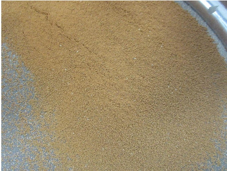
Fotografía 81. Presencia de nódulos de cal.
