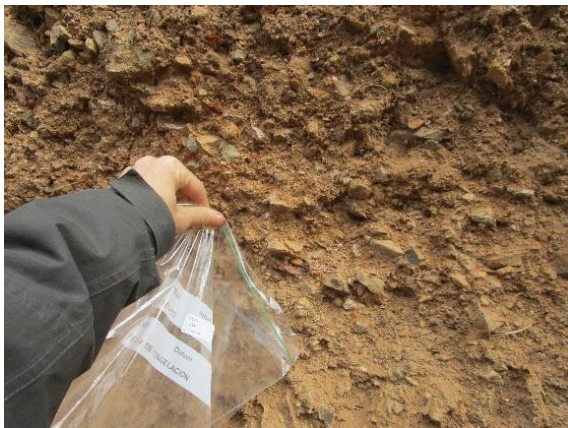
Fotografía 70 y Fotografía 71. Proceso de extracción de la muestra y etiquetado de la bolsa
