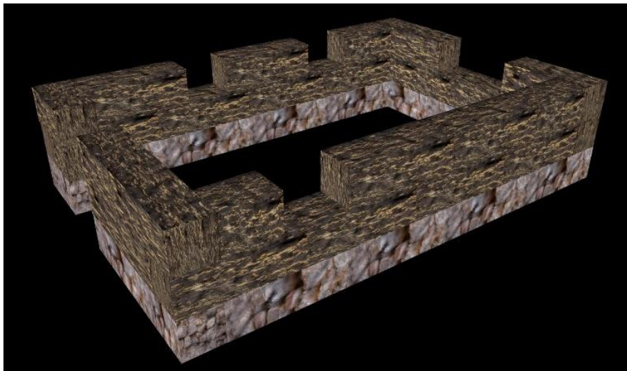
Ilustración 20, Ilustración 21 e Ilustración 22. Formación de la segunda hilada
