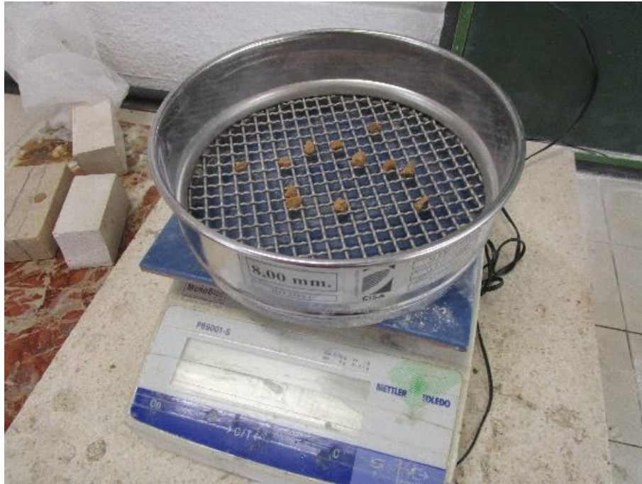
Fotografía 79. Tamiz con muestra en báscula.
