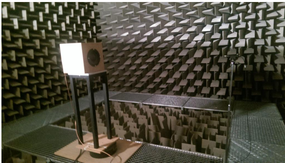
Figura 40: Montaje en la cámara anecoica para la medición de directividad
