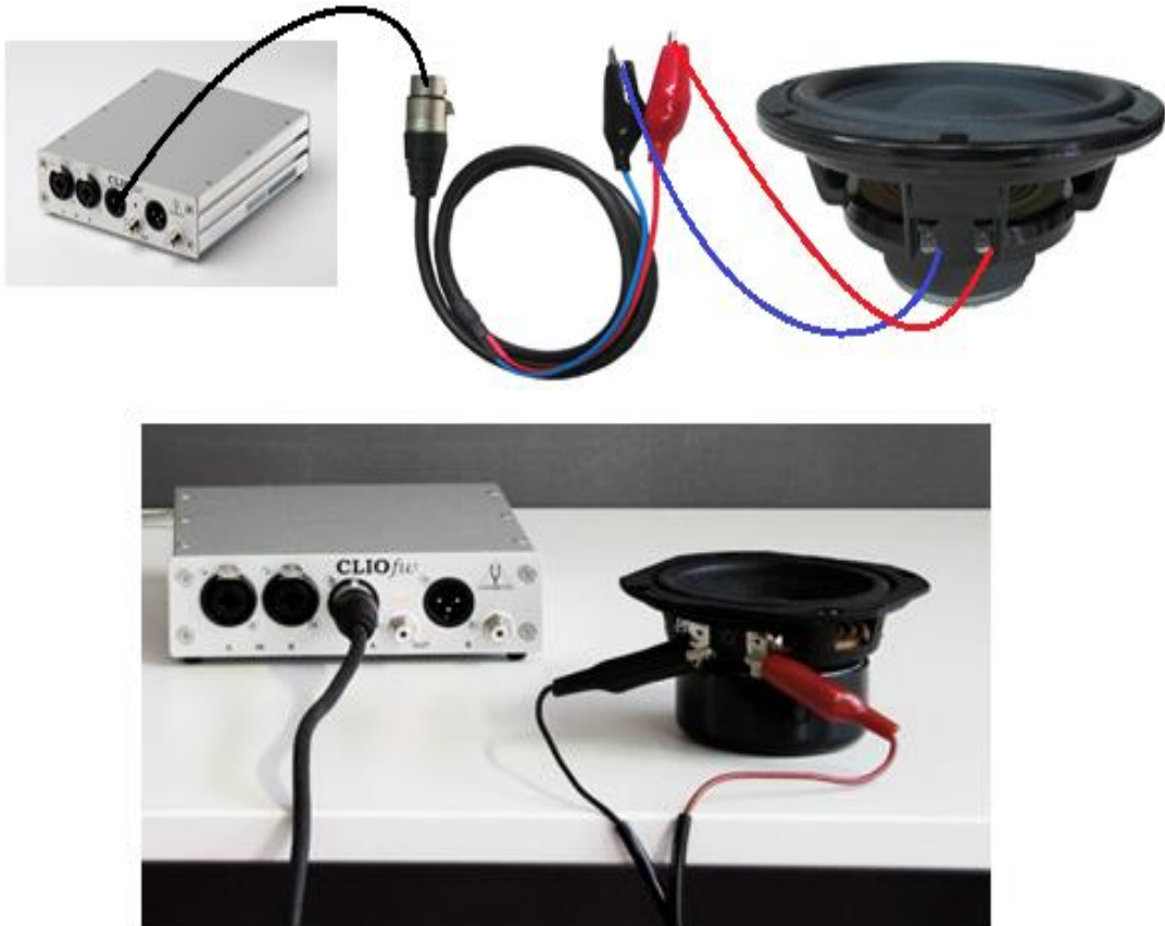
Figura 10: Montaje de la CLIO FW para la medición de impedancia
