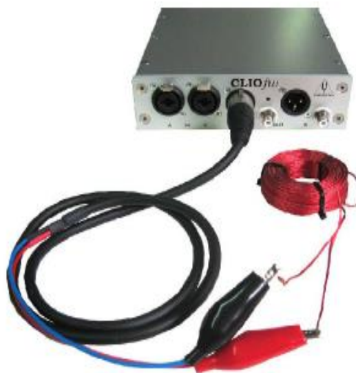
Figura 9: Montaje de la CLIO FW para la medición del inductor
