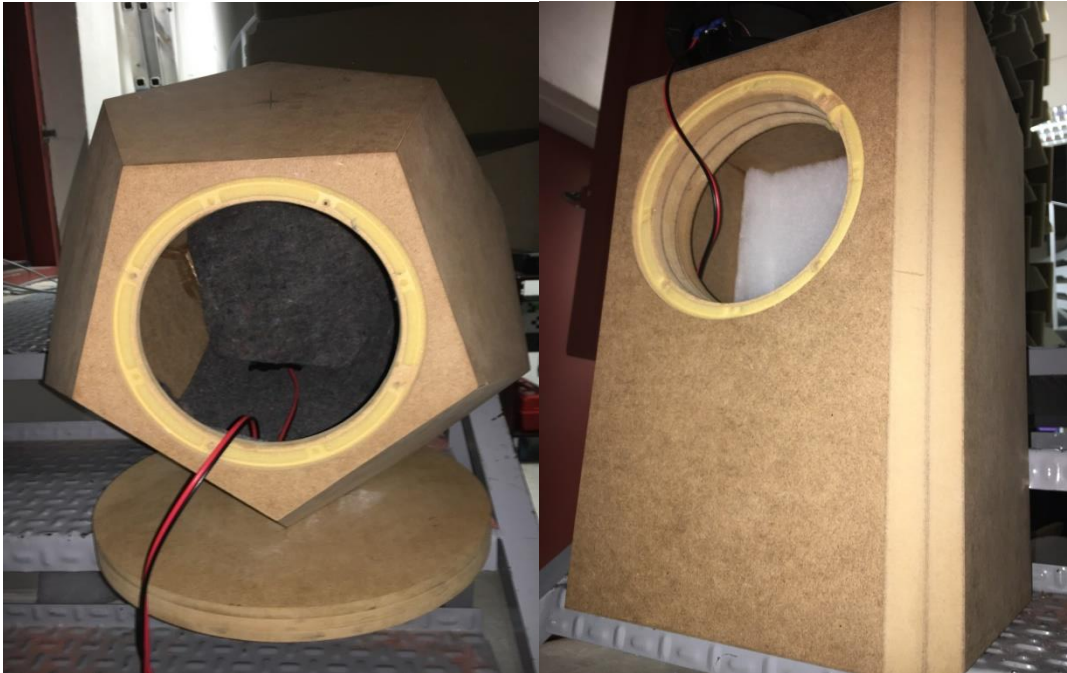
Figura 27: Método de instalación del material acústico absorbente
