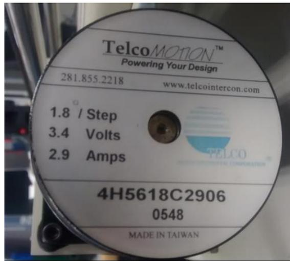
Figura 18. Detalle motor
