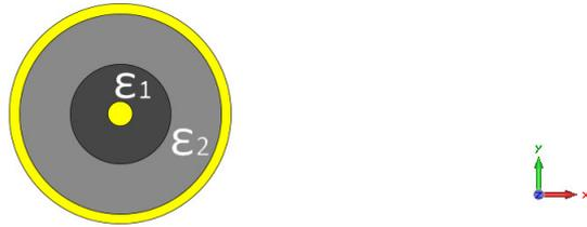
Figura 3.2: Línea de transmisión de dieléctrico no homogéneo
