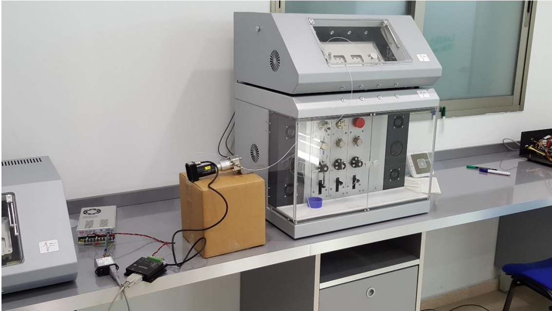
Fig.66 Montaje de la bomba mZR-7240 y conexión con la plataforma A20.
