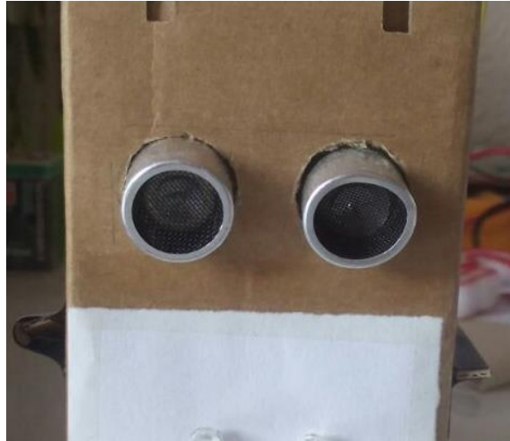
Figura 2.16: Colocación del sensor HC- SR04en el “semáforo”.
