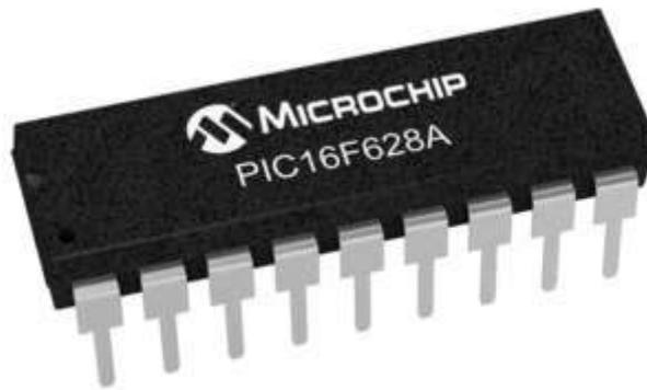
*Figura 7. Microcontrolador PIC [12]*
