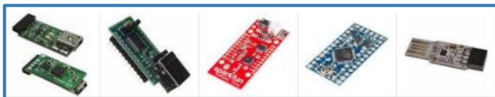
Imagen 13 Ejemplos de Microcontroladores con USB integrado [26]
