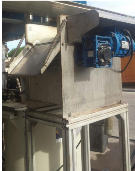
Figura 3. 6. Rotofiltro de tamaño de paso de 0,5 mm, utilizado para el pretratamiento de la FORSU.
