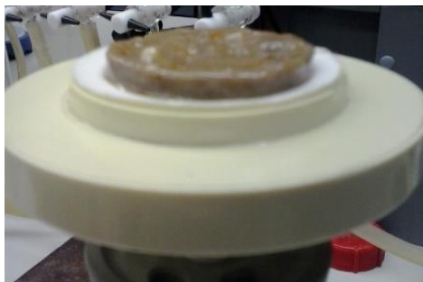
Figura 4. 2. Detalle de colmatación de filtro para la determinación de sólidos suspendidos.
