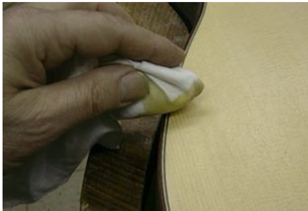
Figura 3.9: Aplicación de barniz por el método muñequilla. Extraída de (López 2008)
