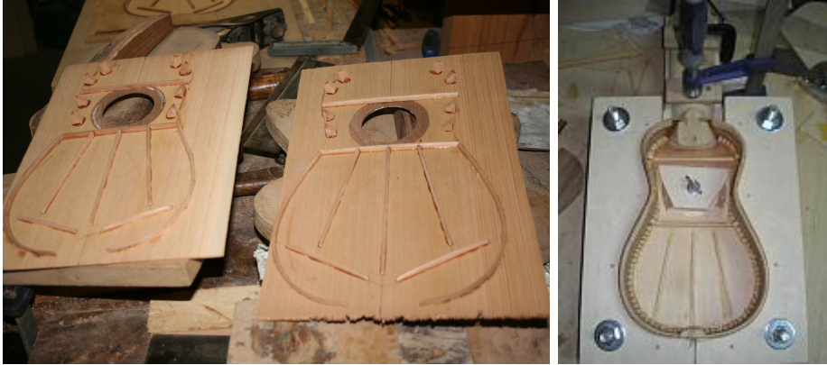
(a) Disposición de barras interiores en los modelos Kima. (b) Proceso de varetaje. Extraída de (Alés 2008)
