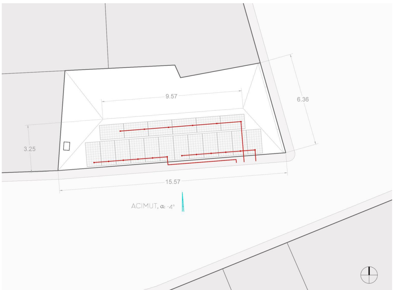
Esquema 6.2. Situación módulos cubierta Ayuntamiento (E. 1:150)
