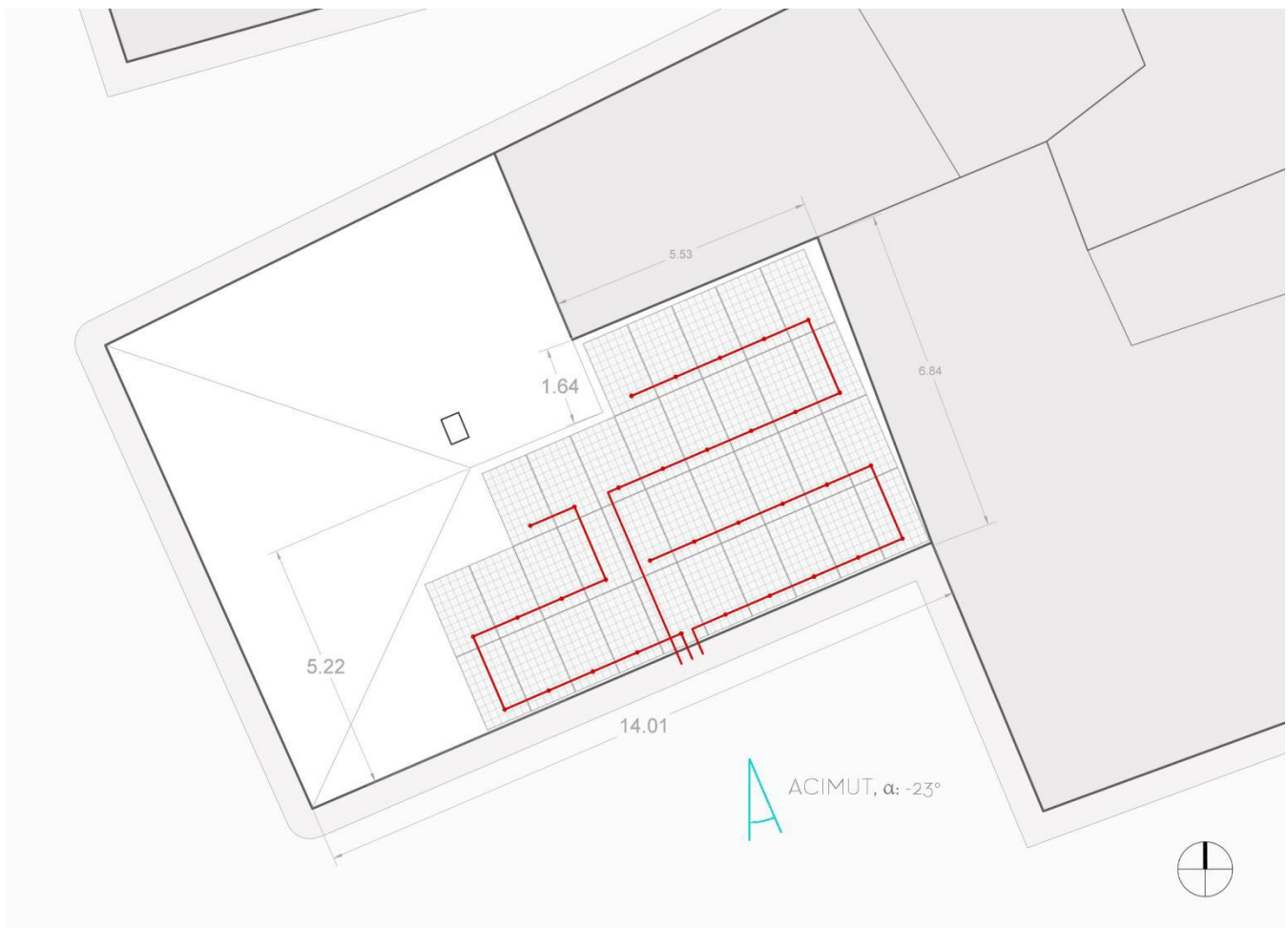
Esquema 6.4. Situación módulos cubierta Escuelas. (E. 1:150)
