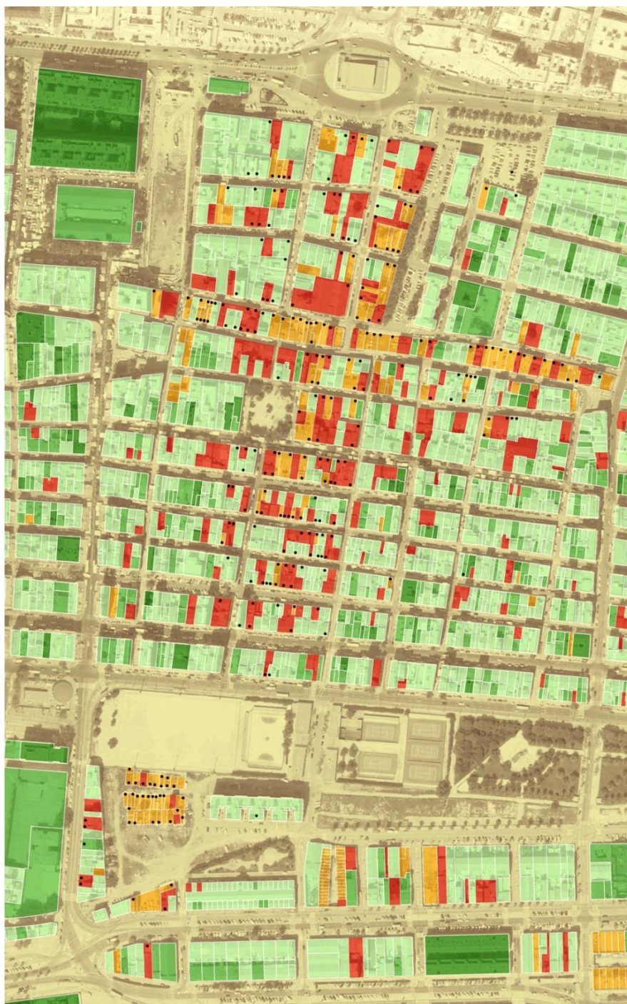
11. Fotoplano actual del centro del barrio del Cabanyal. En verde, las viviendas en buen estado; en rojo, las viviendas en mal estado. En amarillo, los solares. Las viviendas de titularidad pública se encuentran marcadas con un punto negro.
