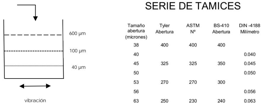
Imagen 4. Clasificación de partículas. Disposición del equipo y tablas de las series Tyler y la US.
