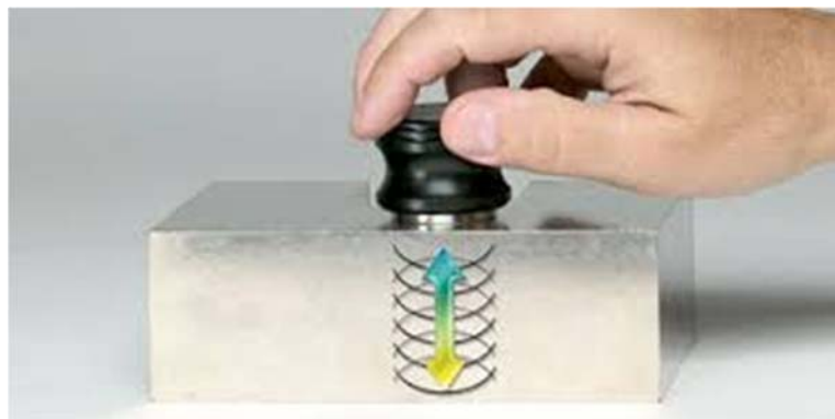
Figura 3. Representación de control de espesores mediante ultrasonidos.
