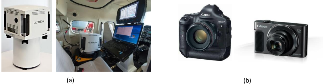
Figura 5: a) Fotogrametría aérea: cámaras métricas; b) Fotogrametría objeto cercano: cámaras de todo tipo.
