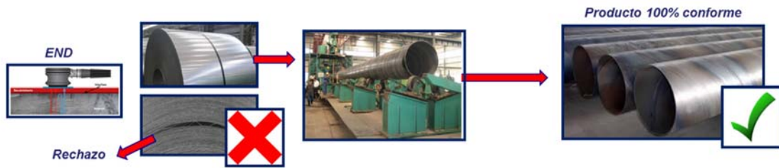
Figura 3. Aplicación de END para la evaluación de la materia prima recibida.
