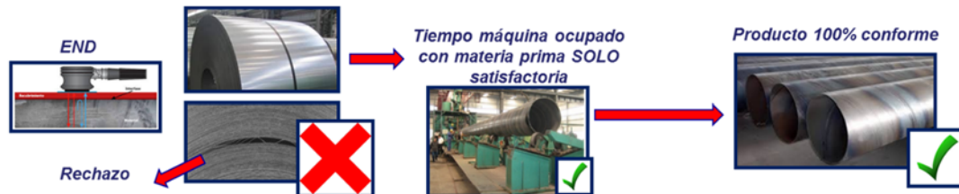
Figura 5. Proceso productivo con optimización de tiempo de máquina mediante aplicación de END.
