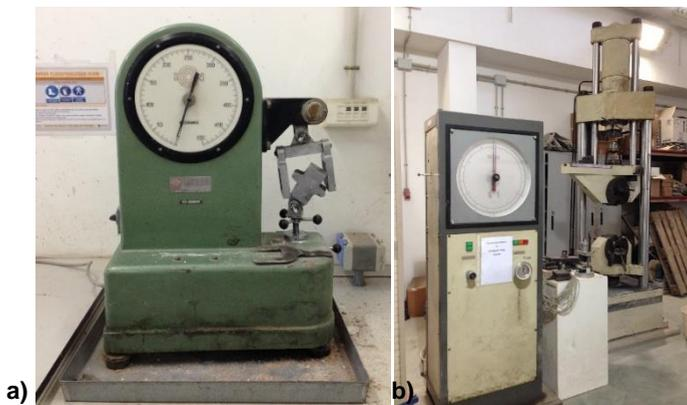
Figura 4.20. Prensas utilizadas para ensayos de flexión (a) y compresión (b) de morteros
