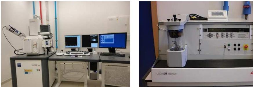
Figura 4.5 Microscopio electrónico de barrido (FESEM)
