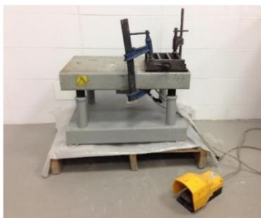
Figura 4.16. Molde sujeto a la mesa vibratoria utilizada
