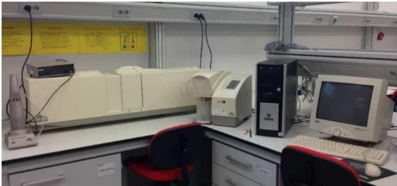
Figura 4.6. Equipo de granulometría por difracción láser
