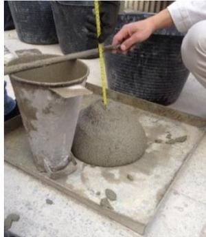
Figura 4.18. Ensayo Cono de Abrams
