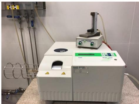
Figura 4.11. Equipo de Termogravimetría
