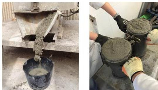
Figura 4.19. Proceso de vertido y vibrado del material
