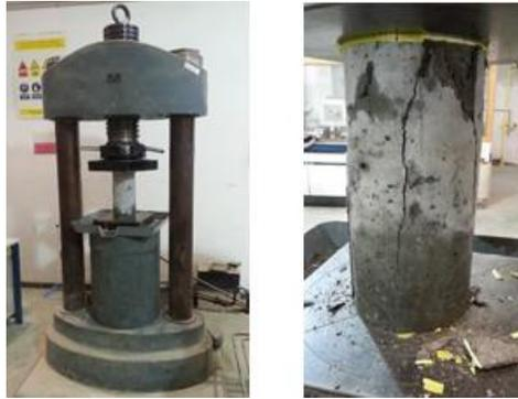
Figura 4.21 Ensayo a compresión probetas cilíndricas
