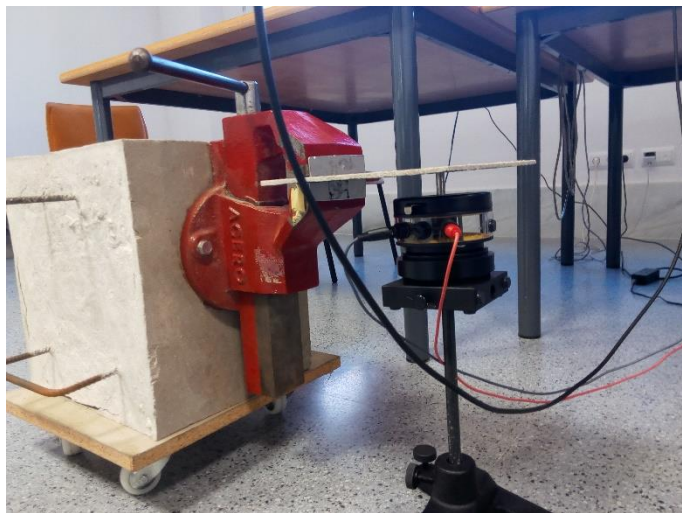
Ilustración 22: Posición Shaker respecto al material a estudiar
