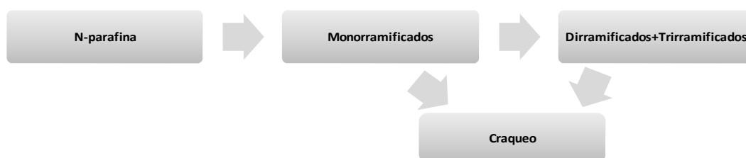
Figura 6.6: Esquema de isomerización seguido por las parafinas n-C_8 , n-C_7 , n-C_6 y n-C_5
