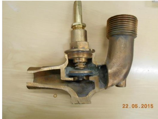
Figura 37. Válvula de asiento plano. Fuente: elaboración propia, 2015
