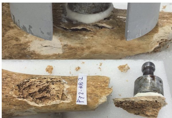
Figura 3. Ensayo de adherencia en P72-ARB
