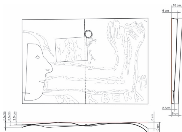
Figura 15. Diagrama de deformación de la obra respecto al plano.
