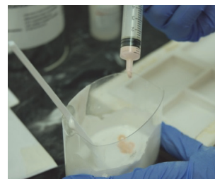
Imagen 3: Adición de pigmentos en pasta a la resina
