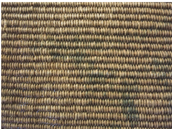
Figura 1. Detalle de ligamento de tafetán con efecto acanalado de las sargas del Palacio Ducal de Gandía.
