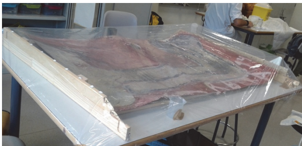
Figura 23. Cámara de humedad.
