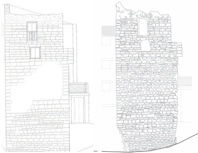
Figura 13. Levantamiento Torre Almenada, en primer lugar dibujo de Vicente Romani y Carmen Solaz (2011) y en segundo lugar dibujo realizado para la investigación presente a través de fotoplano de la figura 7.
