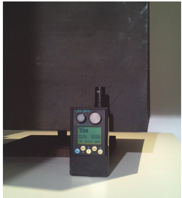
Figura 2. Luxómetro que indica una exposición a 338 luxes de la escultura de Oteiza Caja vacía, ubicada en la cuarta planta del edificio de Sabatini.
