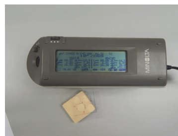
Imagen 14: Espectrofotómetro junto a una de las probetas y el patrón de acetato
