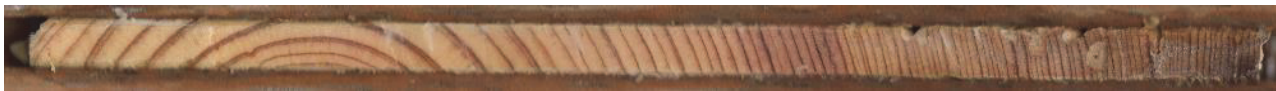
Figura 3. Ejemplo de muestra cilíndrica enrasada y escaneada a 2400dpi para su posterior medición. En la imagen se puede ver claramente la densidad y variabilidad de los anillos de crecimiento
