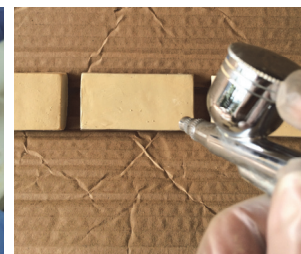
Imagen 4: aplicación de esmalte mediante aerógrafo.
