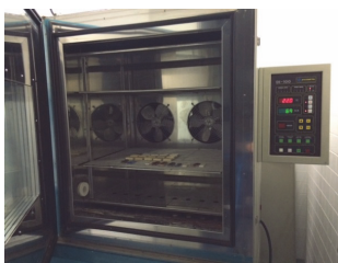
Imagen 8: Cámara climática de humedad y temperatura
