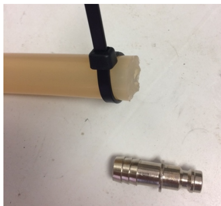
Figura 4.4. Sujeción primitiva del tubo de suministro de O 2 a la conexión de la bomba calorimétrica.
