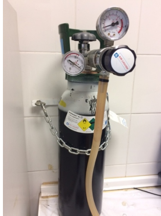
Figura 3.13. Equipo utilizado para el suministro de oxígeno.
