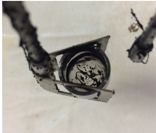
Figura 4.2. Muestra de ácido benzoico tras una combustión completa.
