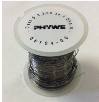
Figura 3.11. Hilo de hierro usado para la ignición.
