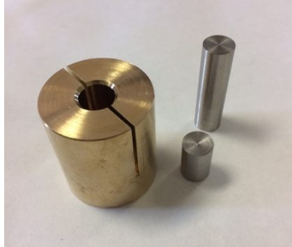
Figura 3.7. Prensa para obtener las pastillas del compuesto a analizar.
