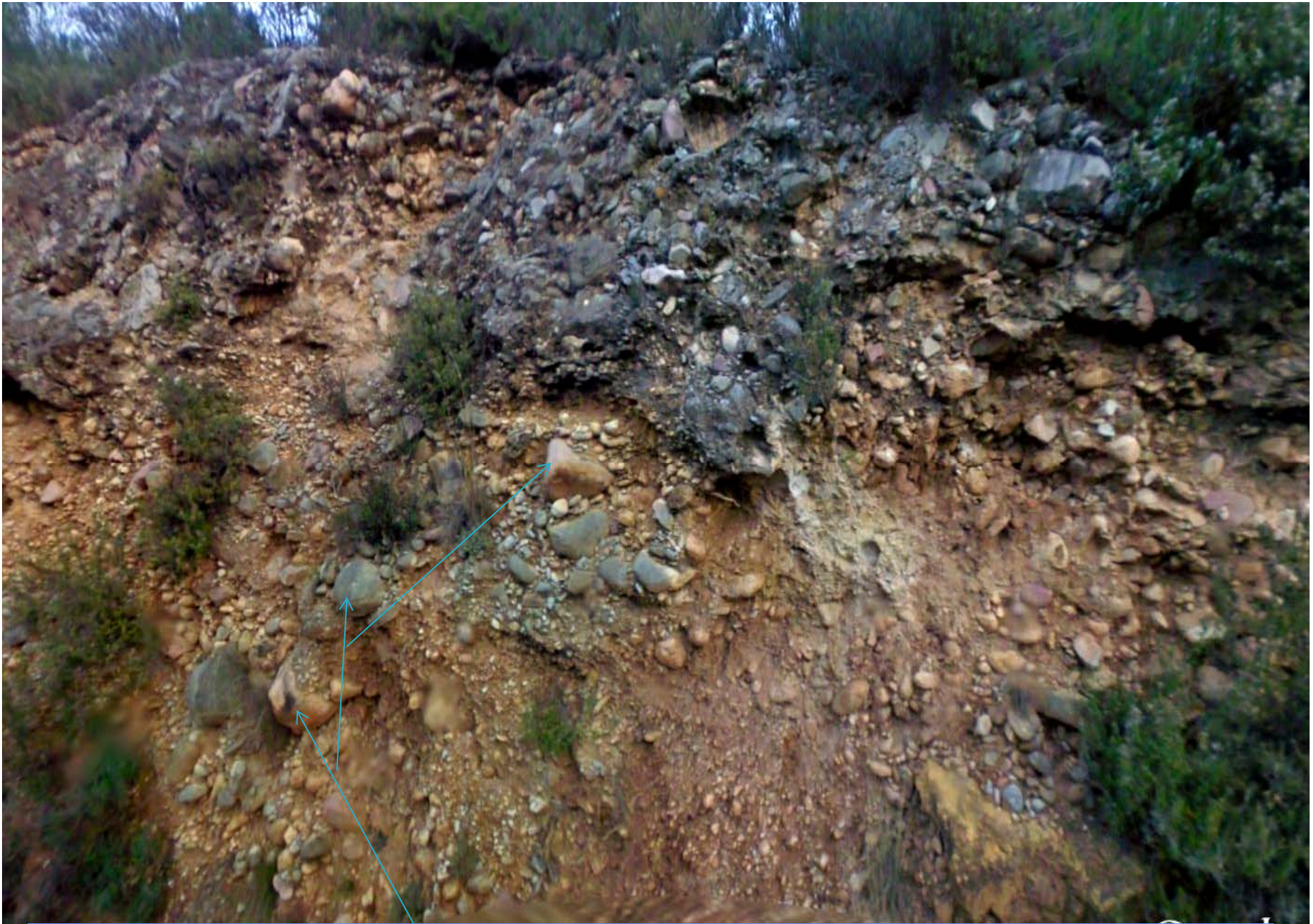
Conglomerado de origen fluvial, de cantos y bloques con bordes algo redondeados (luego no es un depósito de pié de monte); matriz, entre los cantos, arenosa-limosa; algo de cemento carbonatado en parte superior que da resistencia frente a la erosión. Carretera al sur de El Tormo. Castellón
