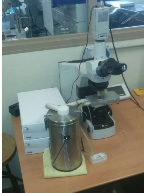
Figura 3. Microscopio óptico Nikon con controlador de temperatura Linksys.
