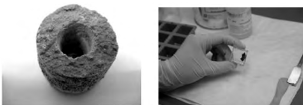
Figura 7. Muestra extraída del paramento y muestra en resina epoxi
