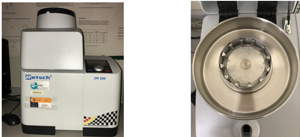
Figura 10 - Molino Ultracentrífugo. Izquierda) Aspecto equipo. Derecha) Detalle del interior del molino.
