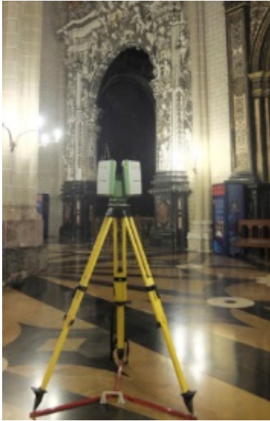
Figura 16: Escáner Leica C10 en las naves de la catedral del Salvador de Zaragoza.
