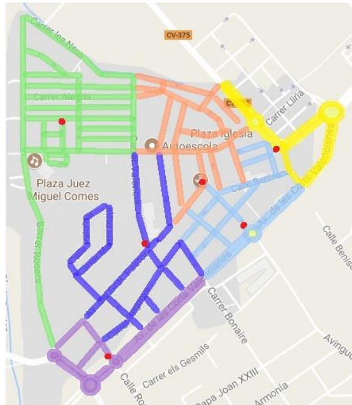
Figura 15: Situación y alcance de los cuadros eléctricos.
