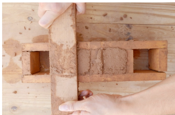
Figura 2. Elaboración de las probetas de adobe mediante molde y presión manual.
