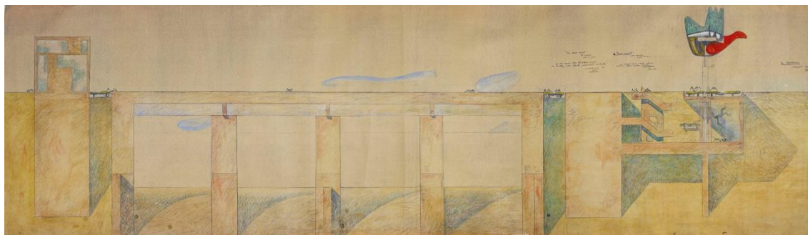
11. Le Corbusier: Detalle de la coronación de la presa de Bhakra con el mirador para visitantes y la Mano Abierta, 1958 (FLC 6272 ©FLC-ADAGP)
