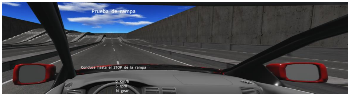
Figura 15. Prueba de rampa con 10% de pendiente. [Fotografía de Marta M. Botella] (CTI – LAUPV 2017).
