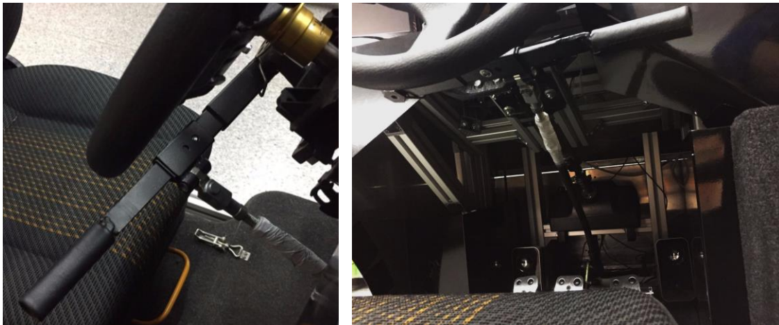
Figura 4. Adaptación palanca de freno. [Fotografía de Marta M. Botella]. (CTI – LAUPV, 2017).
