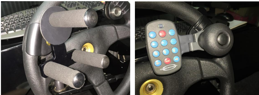
Figura 6. Adaptación e instalación de pomos tetraplejía y simple en el volante. [Fotografía de Marta M. Botella]. (CTI – LAUPV, 2017).
