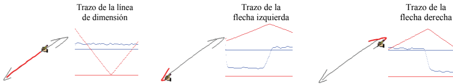
Figura 4.27. Cota diametral de la que se ha calculado la firma polar (en rojo) y la firma de dirección (en azul) de los tres trazos que la integran
