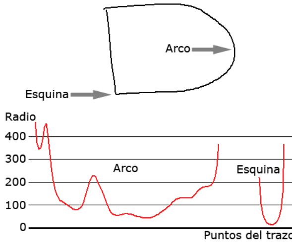
Figura 4.32. Valores de radio para arcos y esquinas en rojo (los valores altos de radio no se han representado)
