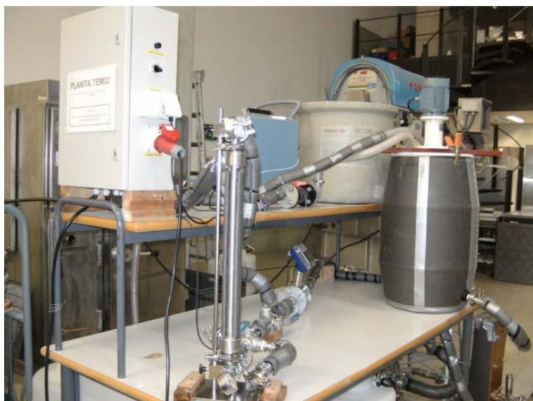
Figura 3. 15. Planta de MF/UF empleada en las experiencias
