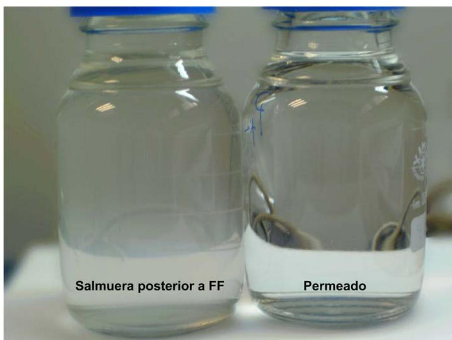
*Figura 7. 25. Muestras de salmuera post FF (cartucho de 10  $\mu$ m) y permeado*
