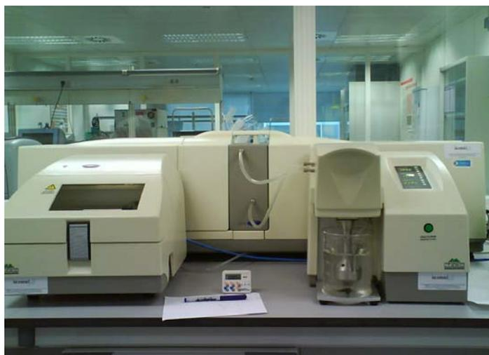
*Figura 3. 4. Equipo de difracción láser Mastersizer 2000 (Malvern Instruments Ltd.)*
