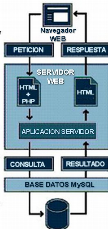
Fig. 5.2.3.1. - Esquema funcionamiento PHP
