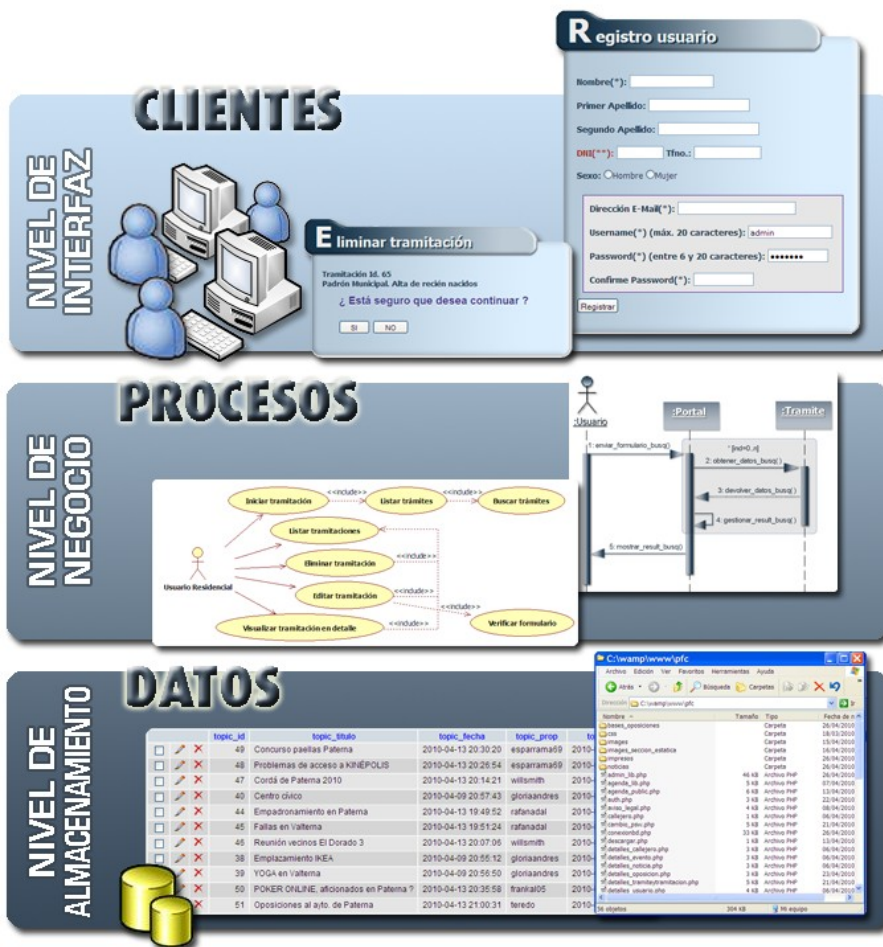
Fig. 4.1.1. – Ejemplo de arquitectura web en base al modelo de 3 niveles
