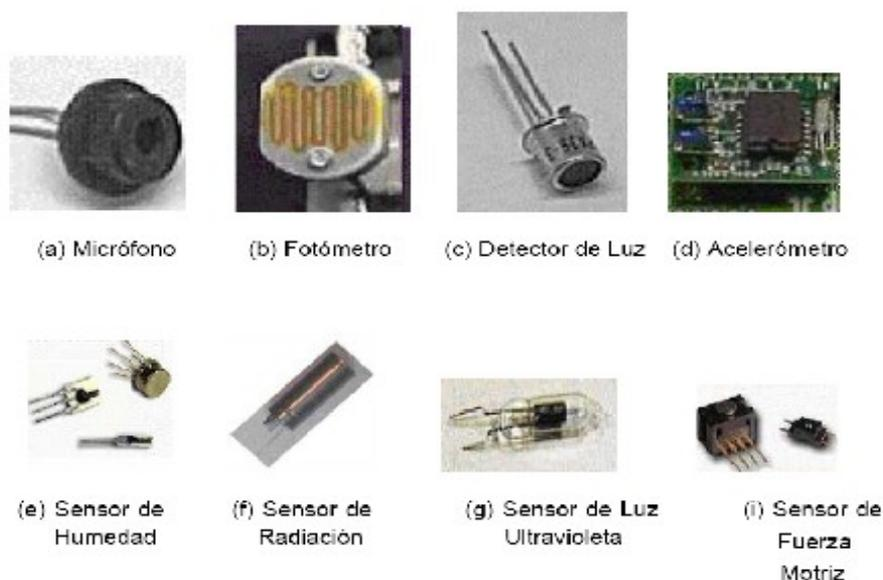
Figura 2.9: Diferentes tipos de sensores
