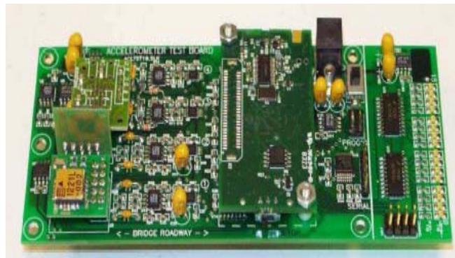
Figura 2.32: Placa del sensor
