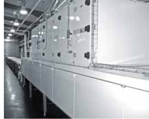
▲ Cooling tunnel | Túnel de enfriamiento | Kühl tunnel
