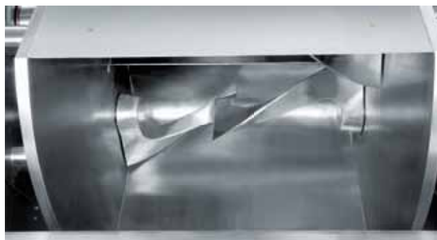
► Kneading arm of a double-Z-kneader Brazo amasador de una amasadora doble Z Knetarm eines Doppel-Z-Kneters
