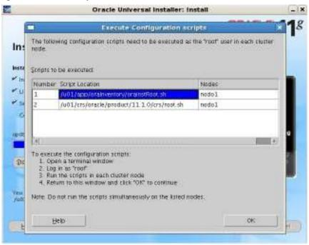
A continuación mostramos el resultado de la ejecución de ambos scripts. Como se puede observar el primero realiza cambios en los permisos de los directorios y el segundo realiza configuraciones sobre el OCR, CRS stack, añade demonios y crea la VIP entre otras cosas:
