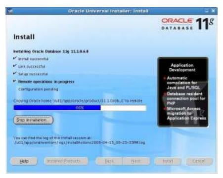
Transcurrido un tiempo de la instalación aparece la pantalla del **asistente de configuración** que, mediante el Oracle Net Configuration Assistant y el Oracle Database Configuration Assistant, realiza la configuración del listener de la base de datos y dispone el software de Oracle para poder ser utilizado.
