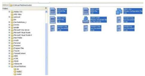
Esto permitía tener **dos máquinas virtuales idénticas** que además compartían almacenamiento. Tras copiar los archivos se editó nodo1.vmx del nodo2 y se cambió el *displayName* = "nodo1" por *displayName* = "nodo2".
