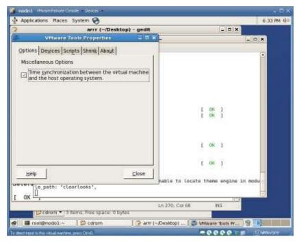
Después de acabar la instalación de las Vmware Tools cerramos la sesión y reiniciamos la máquina. Tras la reiniciación las Vmware Tools estarán ya cargadas y nos será más fácil el trabajo con la máquina virtual.
