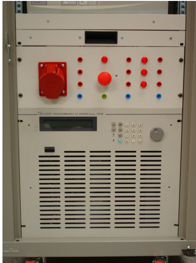
Figura V.128. Detalle de la fuente trifásica programable.
