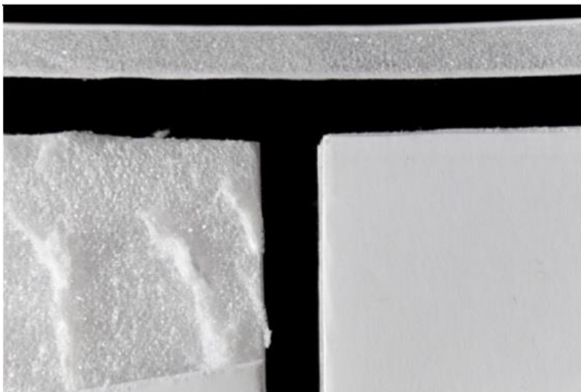
Fig. 28. Fome Core, cartón pluma de protección para reverso de obras de arte - ccfib.mcu.es/patrimonio/docs/MC/POLYEVART/Cartron_pluma_FOME_CORE.pdf .
