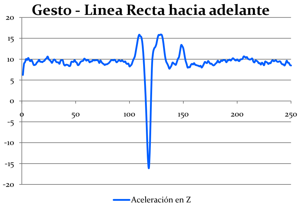
ILUSTRACIÓN 25: GRÁFICA DEL GESTO LINEA RECTA HACIA ADELANTE EN LAS ACELERACIONES DEL EJE Z
