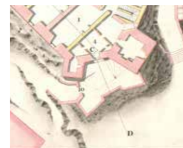
Fig. 4.1.14. Detalle del plano del proyecto de Montaigu de 1730 para el castillo, donde puede apreciarse la primera entrada entre el bastión y el castillo.
