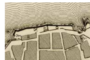
Fig. 4.4.7. Detalle del plano de Suchet (1812). En la leyenda O es el bastión de la Reina, N el del Príncipe, u los almacenes de la artillería y k las letrinas.
