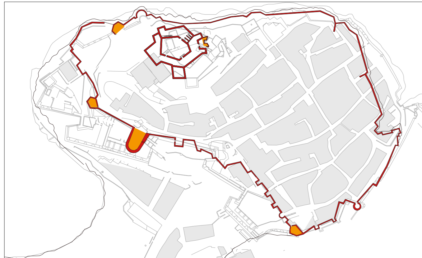
Fig. 3.15. Superposición de la traza de la muralla antigua del plano de Antonelli (en rojo) con la trama actual (en gris), señalando en naranja elementos principales que se realizarían durante la etapa de Carlos V. que hemos identificado al contrastar con plano actual y los memoriales. (MJB 2017).
