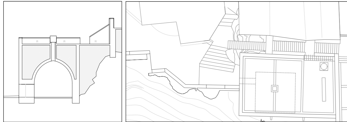
Fig. 4.4.41. Sección y planta del almacén. Proyecto de restauración del Castillo de Peñíscola. Fortificaciones del este. (MJB 2000).
