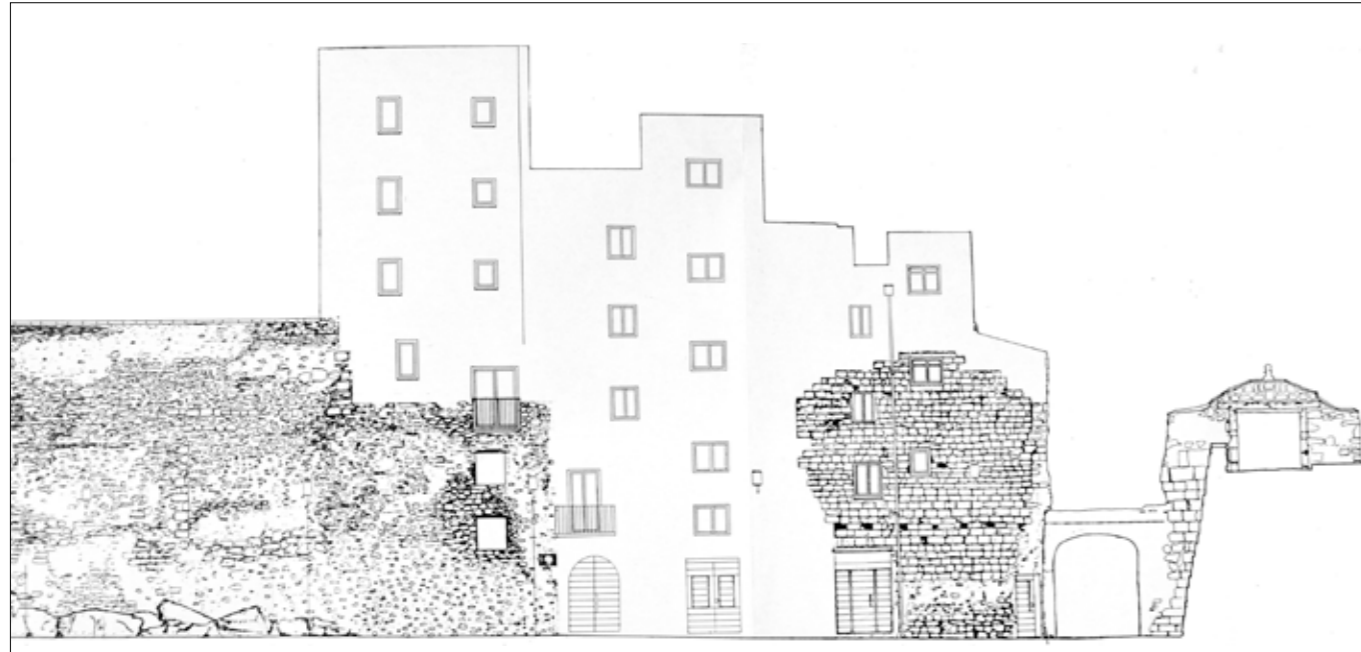
Fig. 4.3.28. Alzado del Proyecto de restauración de la Plaza de les Caseres y murallas de su entorno , donde se ven las edificaciones construidas sobre la muralla y los restos de lienzos de muralla. A la derecha formando la esquina se ven los restos del muro medieval, la puerta de Santa Ana y la sección de la batería de Santa Ana. (MJB 1998).
