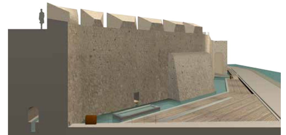
Fig. 4.3.24. Representación virtual de la batería de Santa Ana para el Proyecto de adecuación de la balsa portuaria. Se puede observar la sección de la batería con el conducto abovedado en la base de la muralla. (MJB 2011).
