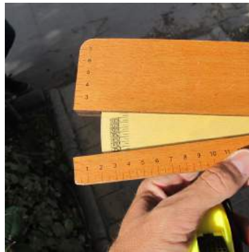
Toma de medida con el inclinómetro para sacar % de las pendientes en las rampas.
