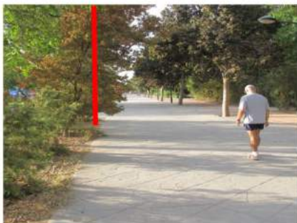
22 Necesidad de poda del arbolado que invade la vertical del recorrido
