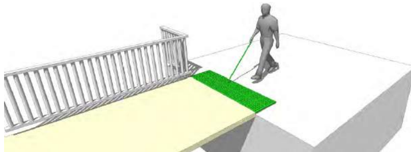
Diferenciación de pavimento al inicio y fin de la pasarela 102 .
