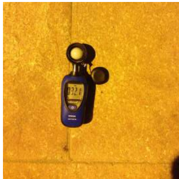
Toma de datos con el luxómetro, para conocer el nivel de iluminación de los itinerarios peatonales
