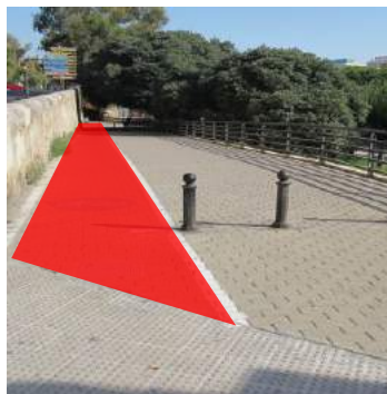
Diferenciación del carril bici con pintura roja
