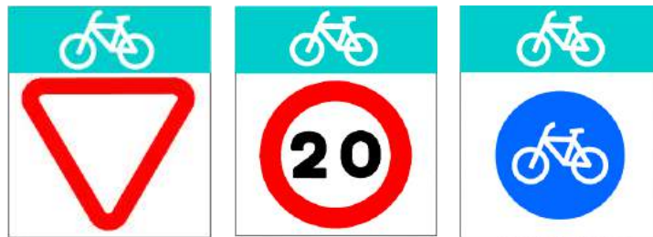
BR1 BR301 BR407 Señalizaciones complementaria que se debería incluir en el carril bici
