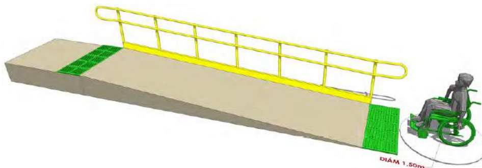
Pavimento táctil señalizador 15
