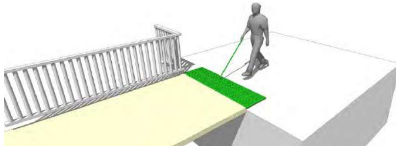
Diferenciación de pavimento al inicio y fin del puente 11
