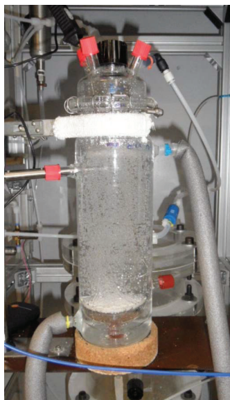
Figura 6.5: Reactor de 1 L con difusor de placa porosa.
