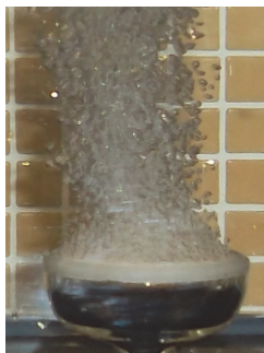
Figura 1.12: Difusor de placa porosa de vidrio en las instalaciones de la Universitat Politècnica de València
