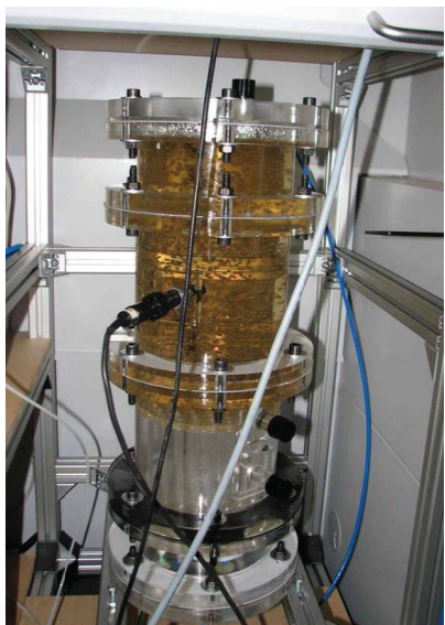
Figura 6.4: Reactor de 10 L modular con distribuidor de gas por capilares.
