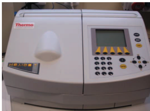
Fig. 3.9. Espectrofotómetro UV-visible empleado para evaluar cambios en la nube.
