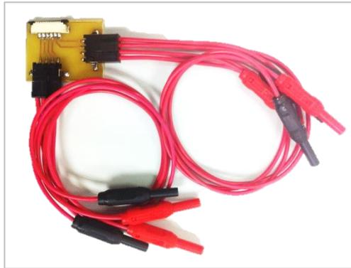
**Figura 2-12.** PCB adaptadora para la medida de la impedancia de la matriz de electrodos TCBs.
