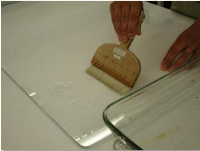
Ilustración 54: Preparando el tissue RK-0 con Klucel G, cubriéndolo con una pantalla de fibra de vidrio (Ubbink, 2003, p.45).
