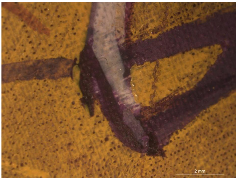
Ilustración 35: Microfotografía x10. Por los cambios dimensionales del tejido y de la película pictórica del país del abanico, junto al movimiento de apertura y cierre se pueden apreciar los desprendimientos en el estrato pictórico. Cortesía de S. Vicente Palomino y D.J. Yusá Marco.
