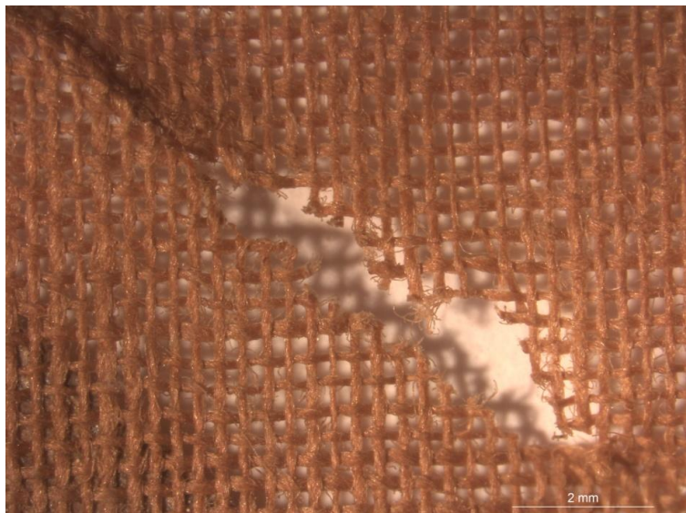
Ilustración 44: Microfotografía x10 de la rotura en la doblez de un paño de tafetán marrón. Cortesía de S. Vicente Palomino y D.J. Yusá Marco.
