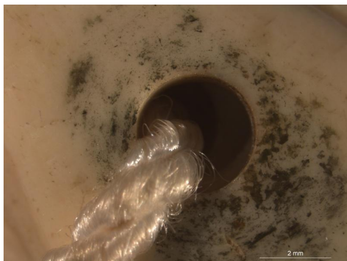
Ilustración 21: Microfotografía x10 del agujero de cosido de una lentejuela. Se pueden ver los efectos del óxido sobre. Cortesía de S. Vicente Palomino y D.J. Yusá Marco.
