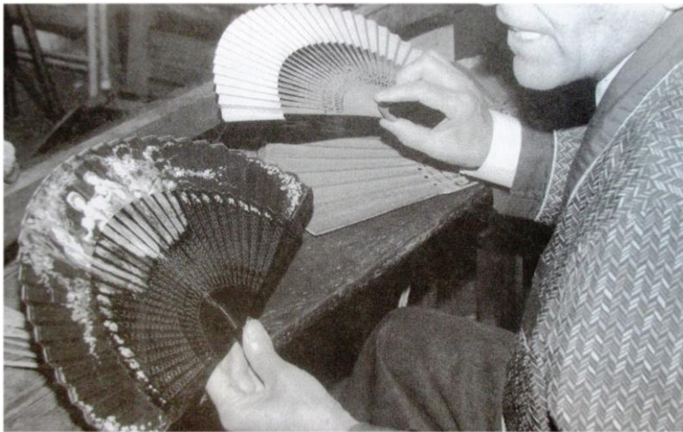
Ilustración 27: Gerardo Vacas muestra un abanico acabado con el detalle de treintaicinco agujeros de entrada de la sierrecita de calar (Tarín, 1997, p.118).
