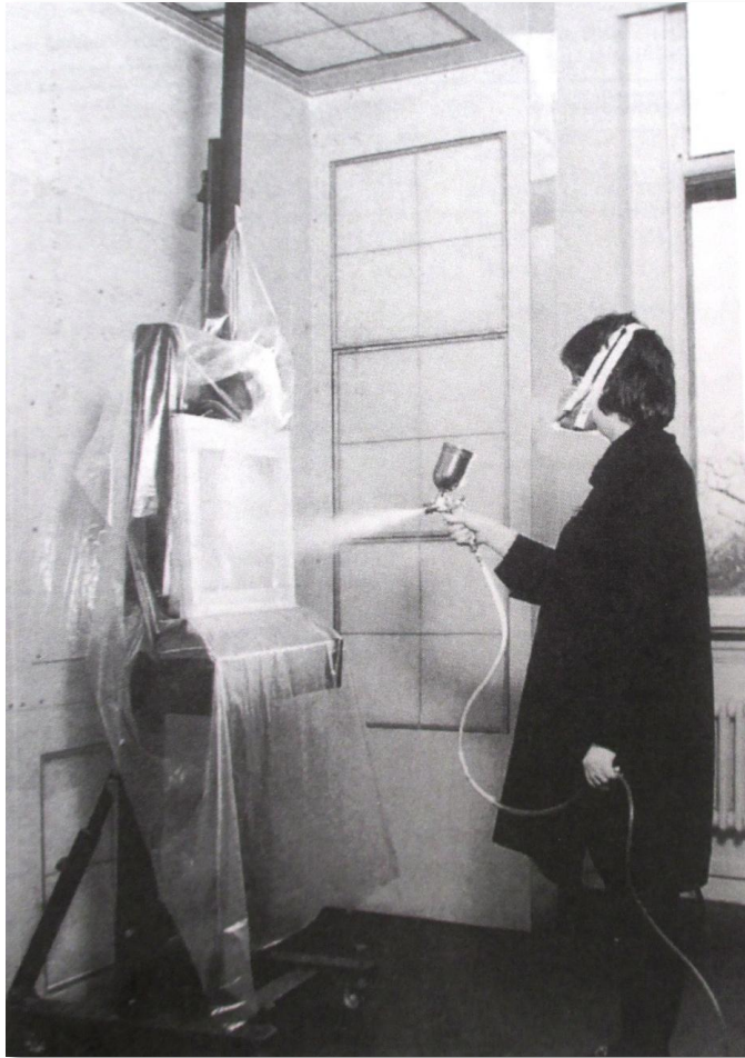
Ilustración 44: Beva 371 aplicada en spray. Este método permite la preparación de grandes soportes adhesivos (Brooks, 2011, p.479.).
