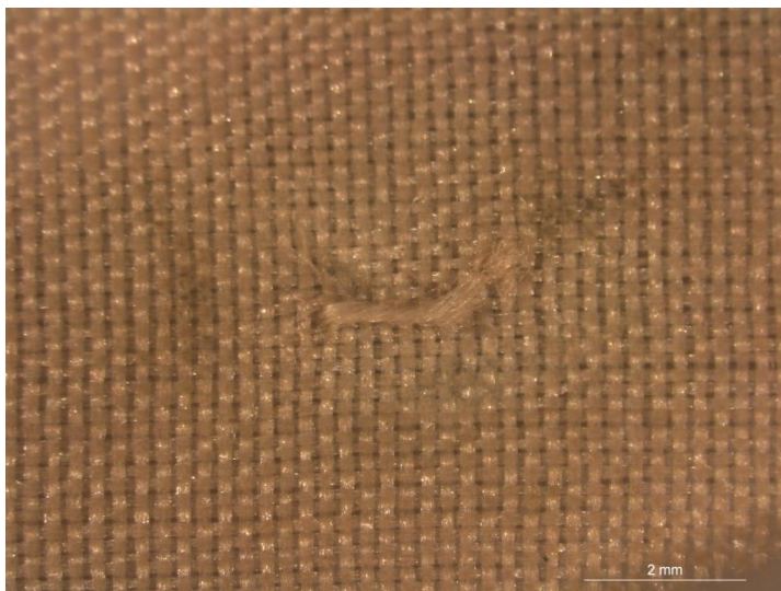
Ilustración 58: Microfotografía x10 del país de una abanico con ligamento de tafetán, con un hilo que anteriormente sujetaba una lentejuela. Cortesía de S. Vicente Palomino y D.J. Yusá Marco.
