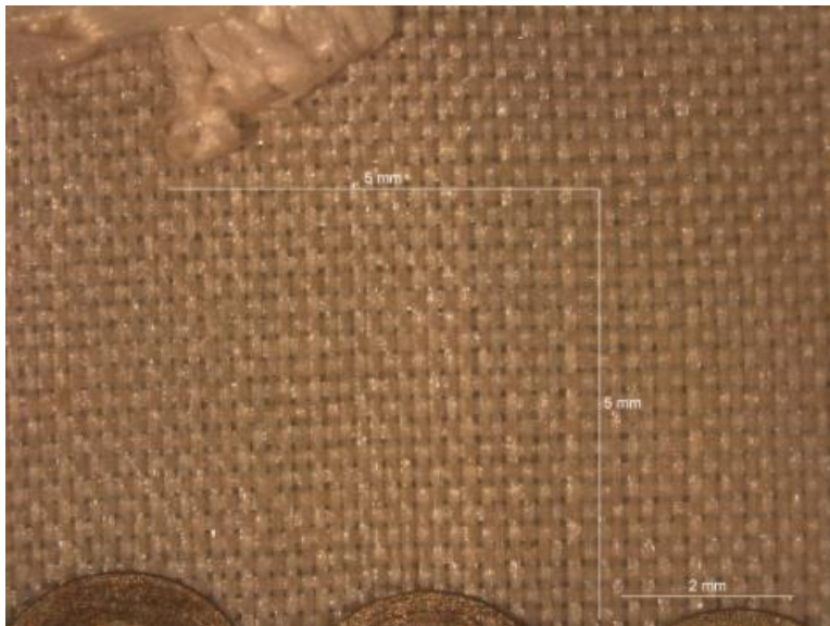
Ilustración 6: Microfotografía x10 de un tafetán de seda sin torsión tipo "habutae" o ponguis. Cortesía de S. Vicente Palomino y D.J. Yusá Marco.
