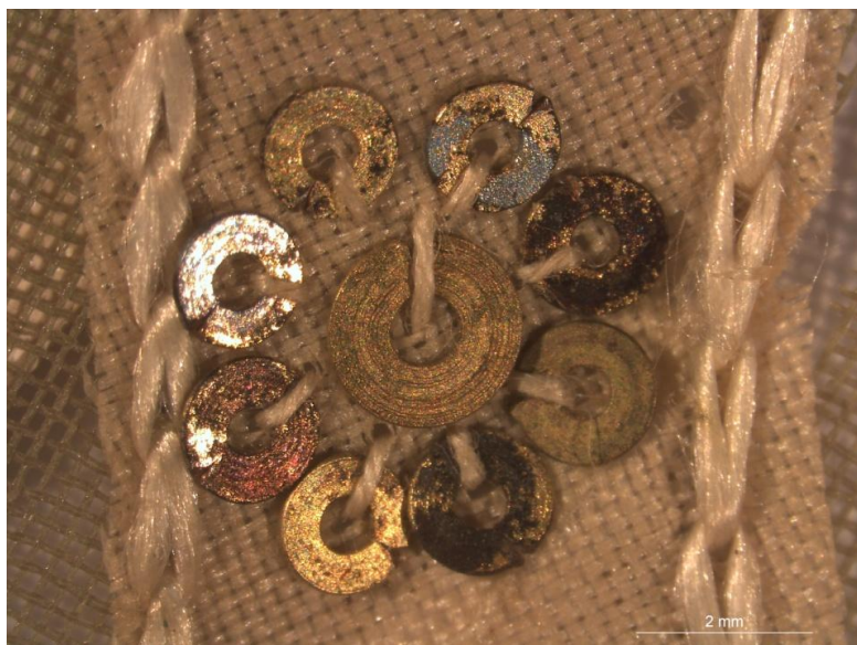
Ilustración 32: Una alta humedad relativa favorece la corrosión de elementos metálicos. Cortesía de S. Vicente Palomino y D.J. Yusá Marco.
