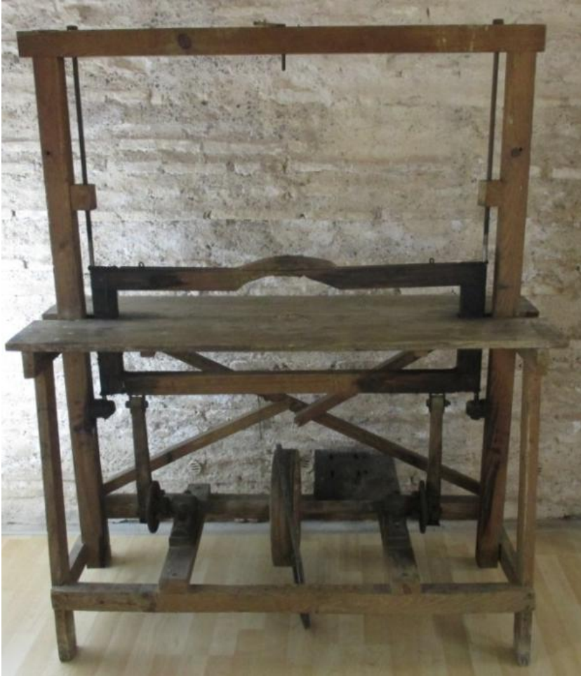
Ilustración 11: Caladora a pedal del siglo XIX. Museo del Abanico de Aldaia.
