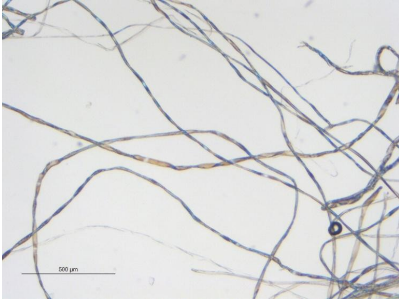
Ilustración 10: Microfotografía x4 y 90° de las características morfológicas de la fibra de algodón. Cortesía de S. Vicente Palomino y D.J. Yusá Marco.
