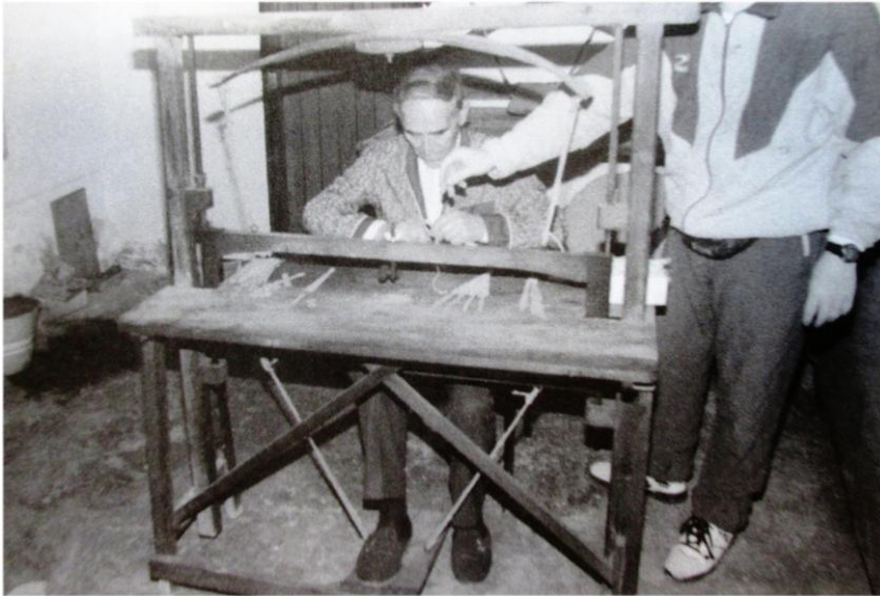
Ilustración 26: El maestro artesano Gerardo Vacas con su hijo David en la primitiva máquina caladora de ballesta (Tarín, 1997, p.117).
