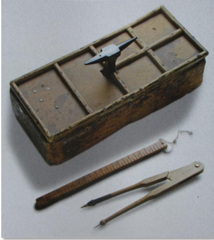
Ilustración 30: Incluseta para remachar o poner los clavos del abanico. Pulgadero o regla para medir los países o telas del abanico provista de las marcas de medición. Compás de madera y hierro para marcar las telas. De Aire Are. Sucesores de Barber y Lorca. (De la Puerta, 2005, p.178)
