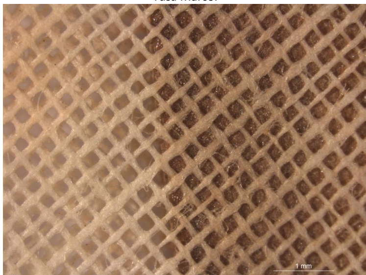
Ilustración 26: Microfotografía x16 del amarilleamiento del tejido por el contacto con la madera del varillaje. Cortesía de S. Vicente Palomino y D.J. Yusá Marco.
