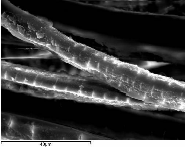
Ilustración 11: Imagen SEM x1500 de electrones secundarios de fibras de seda con sericina fracturada. Cortesía de S. Vicente Palomino y D.J. Yusá Marco.
