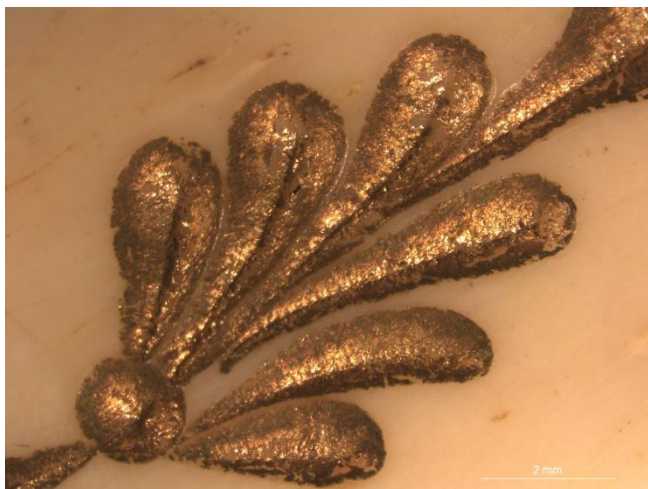
Ilustración 14: Microfotografía x10 de la pintura con purpurina de una varilla. Cortesía de S. Vicente Palomino y D.J. Yusá Marco.
