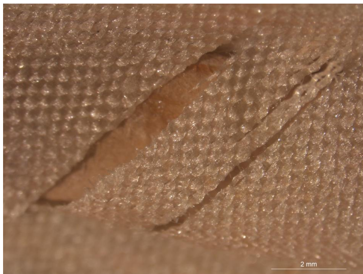
Ilustración 57: Microfotografía x10 de la rotura del tejido del país del abanico en una de las varillas del mismo. Cortesía de S. Vicente Palomino y D.J. Yusá Marco.
