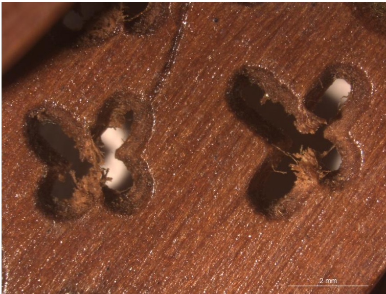
Ilustración 10: Microfotografía x10 de un trabajo de calado en un varillaje de madera. Cortesía de S. Vicente Palomino y D.J. Yusá Marco.
