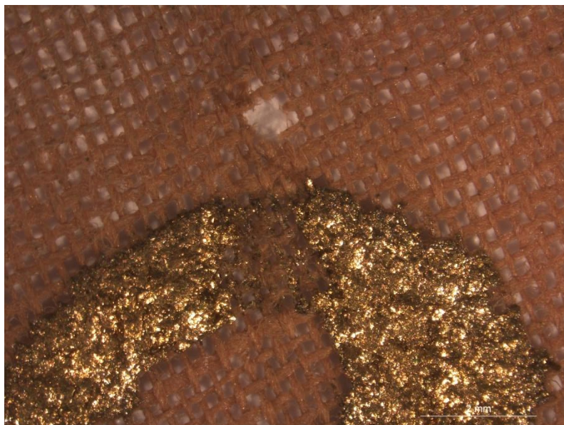
Ilustración 24: Microfotografía x10 de un pliegue del abanico en el que hay un faltante de decoración de purpurina así como un agujero por desgaste del mismo. Cortesía de S. Vicente Palomino y D.J. Yusá Marco.
