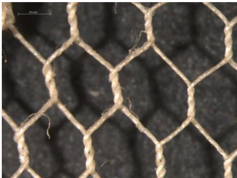
Ilustración 8: Microfotografía x20 de un tul de seda, fondo de un país de encaje. Cortesía de S. Vicente Palomino y D.J. Yusá Marco.
