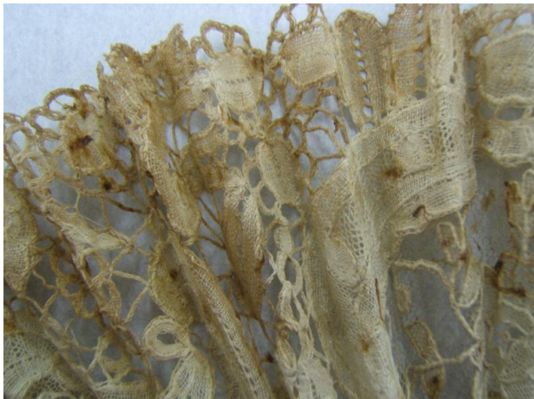
Ilustración 31: Detalle del paño anterior. La variación en los ciclos de humedad relativa ha creado fatiga en el tejido. Cortesía de S. Vicente Palomino y D.J. Yusá Marco.
