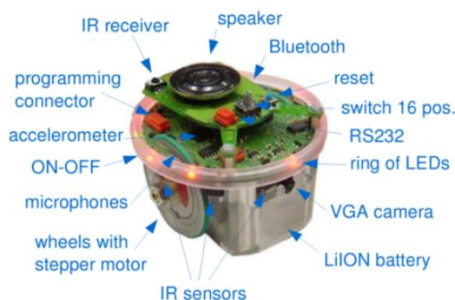
**Figura 7.21:** Robot móvil diferencial e-puck
