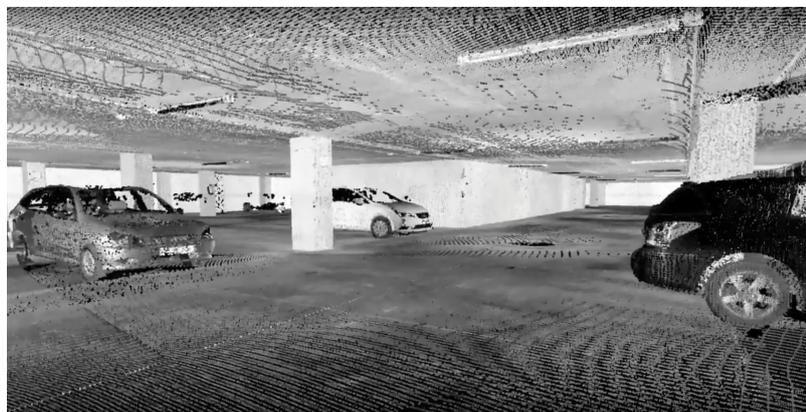
Figura 7.6: Captura del resultado del escáner 3D en el entorno del garaje.
