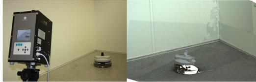
**Figura 4.14:** (Izq) Escáner 3D para la obtención de las medidas del entorno utilizadas para medir la precisión del algoritmo  $GEMA^2$ . (Der) Nube de puntos 3D obtenida.
