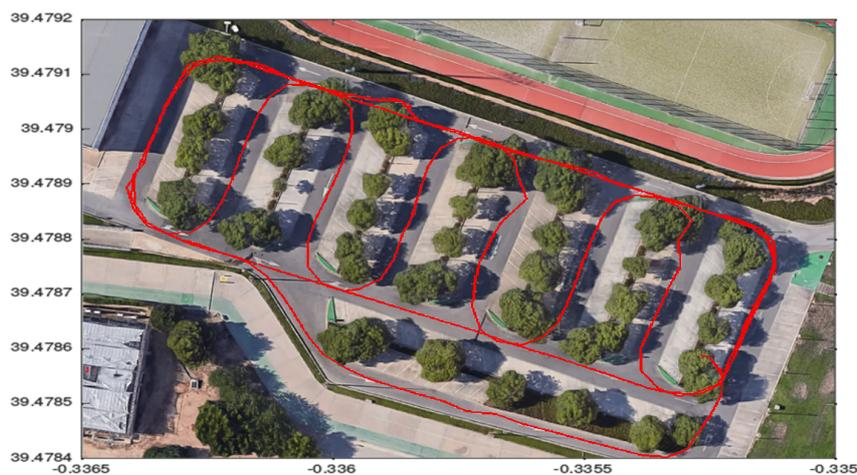
**Figura 5.13:** Prueba Rbcar en exteriores con el GPS VBOX. Trayectorias georeferenciadas sobre la imagen satelital de un parking de la UPV obtenida por Google Earth<sup>®</sup>.
