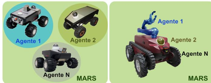
**Figura 2.3:** A la izquierda se muestra una arquitectura MARS aplicada a alto nivel donde cada agente representa un robot y a la derecha se muestra un ejemplo de una arquitectura MARS aplicada a bajo nivel donde cada agente representa un componente o una funcionalidad.
