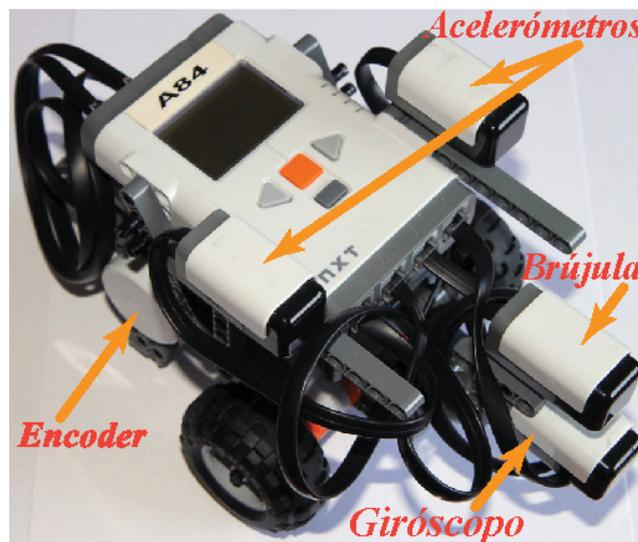
Figura 3.5: Robot móvil diferencial contruido con el LEGO NXT
