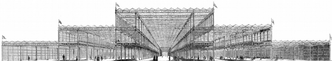
Figura 2.3.1: Sección constructiva del edificio del Crystal Palace de Londres de 1851. Fuente: [Berlyn y Fowler, 1851, p. 1]
