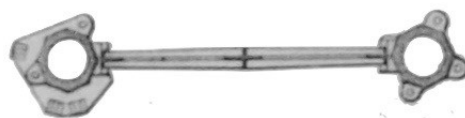
Figura 3.7.4: Detalle del arriostramiento de las columnas bajo la cúpula. Imagen extraída de [Carstensen & Gildemeister, 1854]
